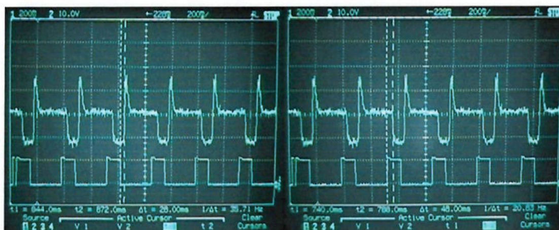
Figura 43 – Resposta do sistema completo (freq. 20Hz - T_s : 28ms e T_{descida} : 48ms).
