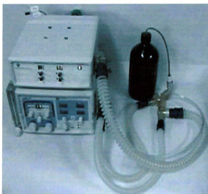
Figura 42 – Sistema completo com simulador de pulmão neonatal.
