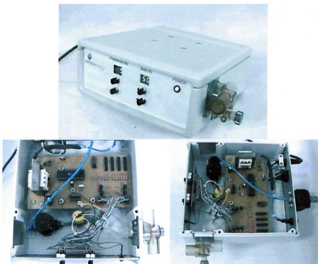
Figura 18 - Equipamento utilizado para ensaio da Válvula Proporcional e Digital.
