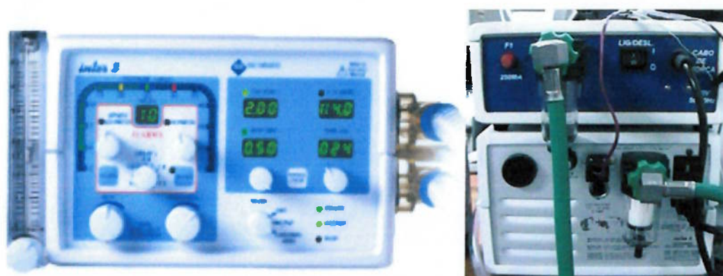
Figura 19 - Ligação do aparelho com o sensor de pressão do Inter 3 .
